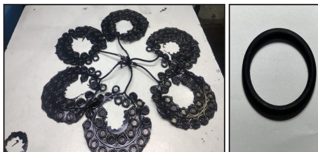
Figura 1. À esquerda são anéis de vedação semiacabados (com rebarbas) e, à direita, há um exemplar de anel de vedação após acabamento.
