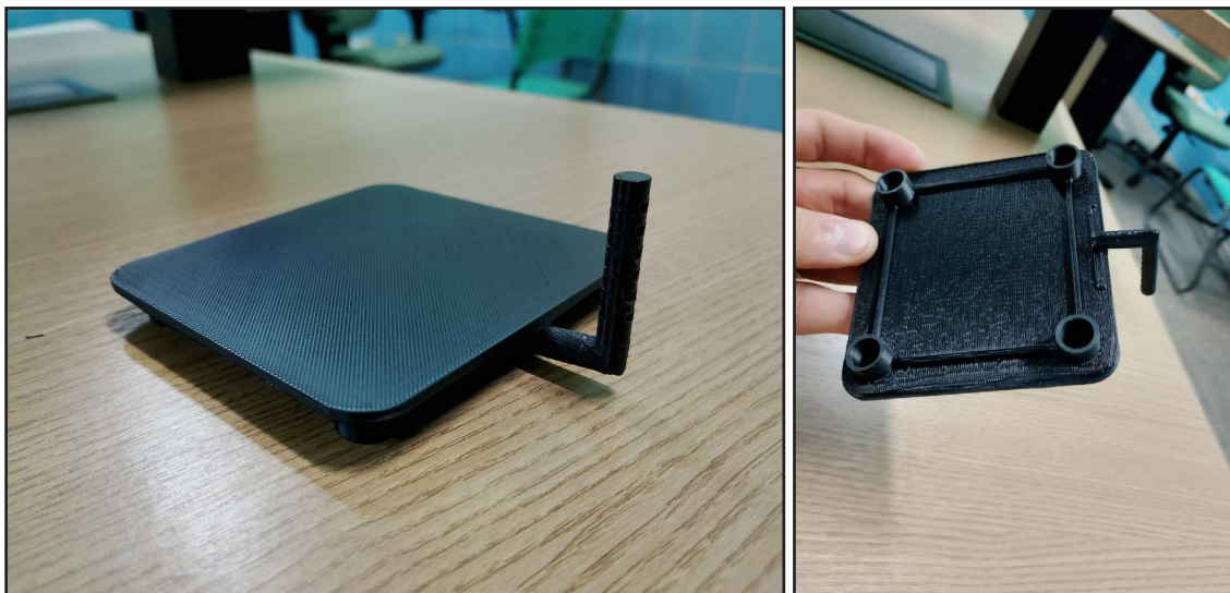
Figura 7. Assento em 3D (vista superior e inferior)
