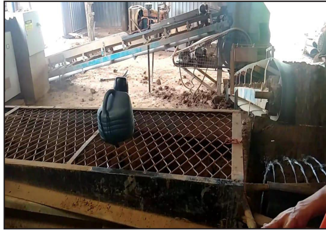
Figura 9. Processo de hidratação da argila
