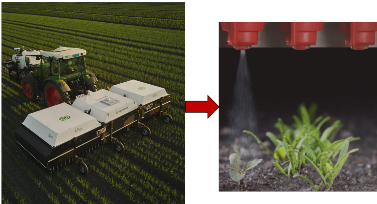
Figura 3. Sistema ARA de pulverização seletiva desenvolvido pela Ecorobotix, equipado com câmeras, sensores, GPS e inteligência artificial para identificação de plantas daninhas e aplicação localizada de herbicidas em tempo real
