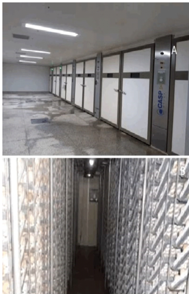
Figura 2. A) Sala de incubação contendo cinco incubadoras de múltiplos estágios. B) Interior de uma incubadora de múltiplos estágios CASP CMg 125 HT com capacidade para 124.416 ovos. Fonte: Arquivo do autor
